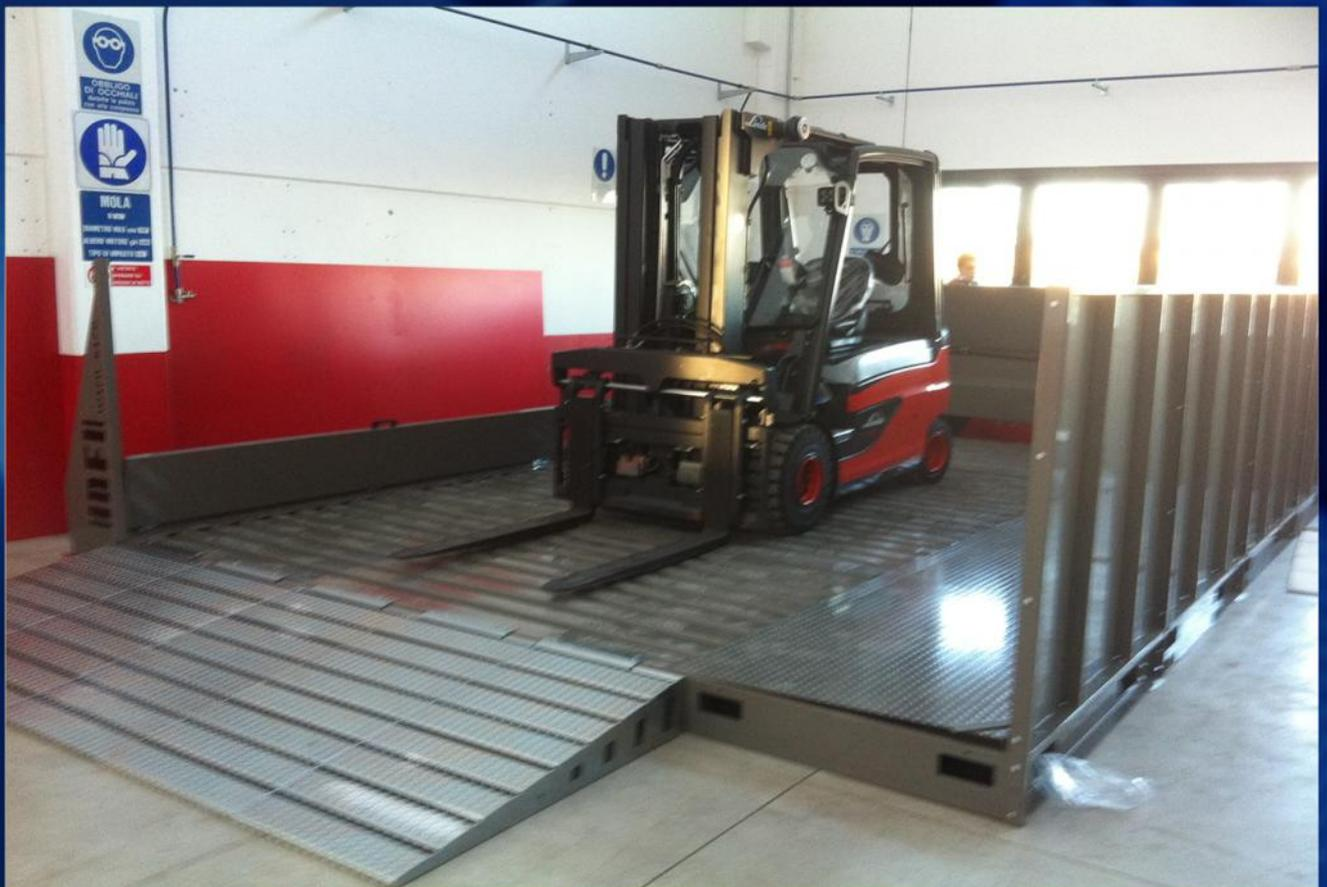
Stazione di lavaggio con 3 moduli pavimentazione BASIC e pedana
